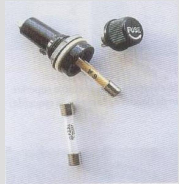
**Pequenos filamentos metálicos de baixa resistência que fundem ( sólido → líquido ) quando a temperatura do fio aumenta excessivamente.**
