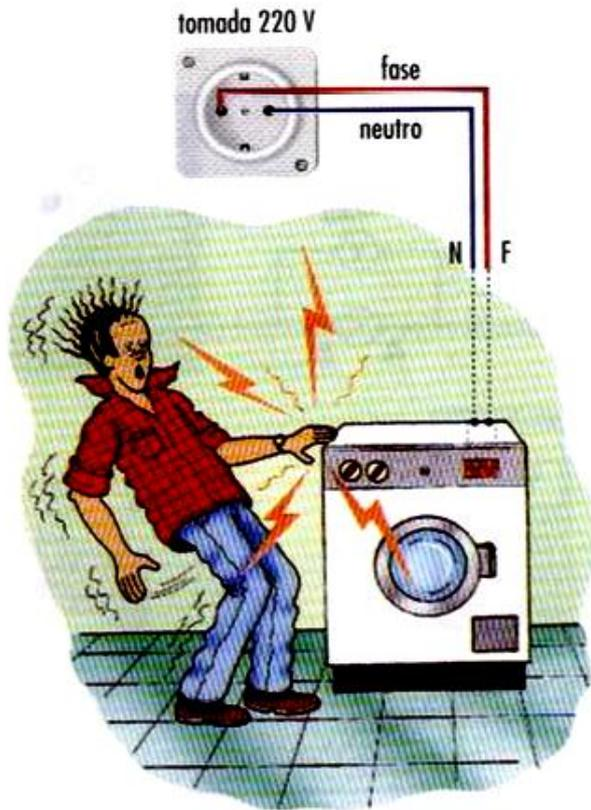
Não havendo fio de Terra ao tocarmos num aparelho ligado à corrente elétrica, mas mal isolado, levamos um choque.
