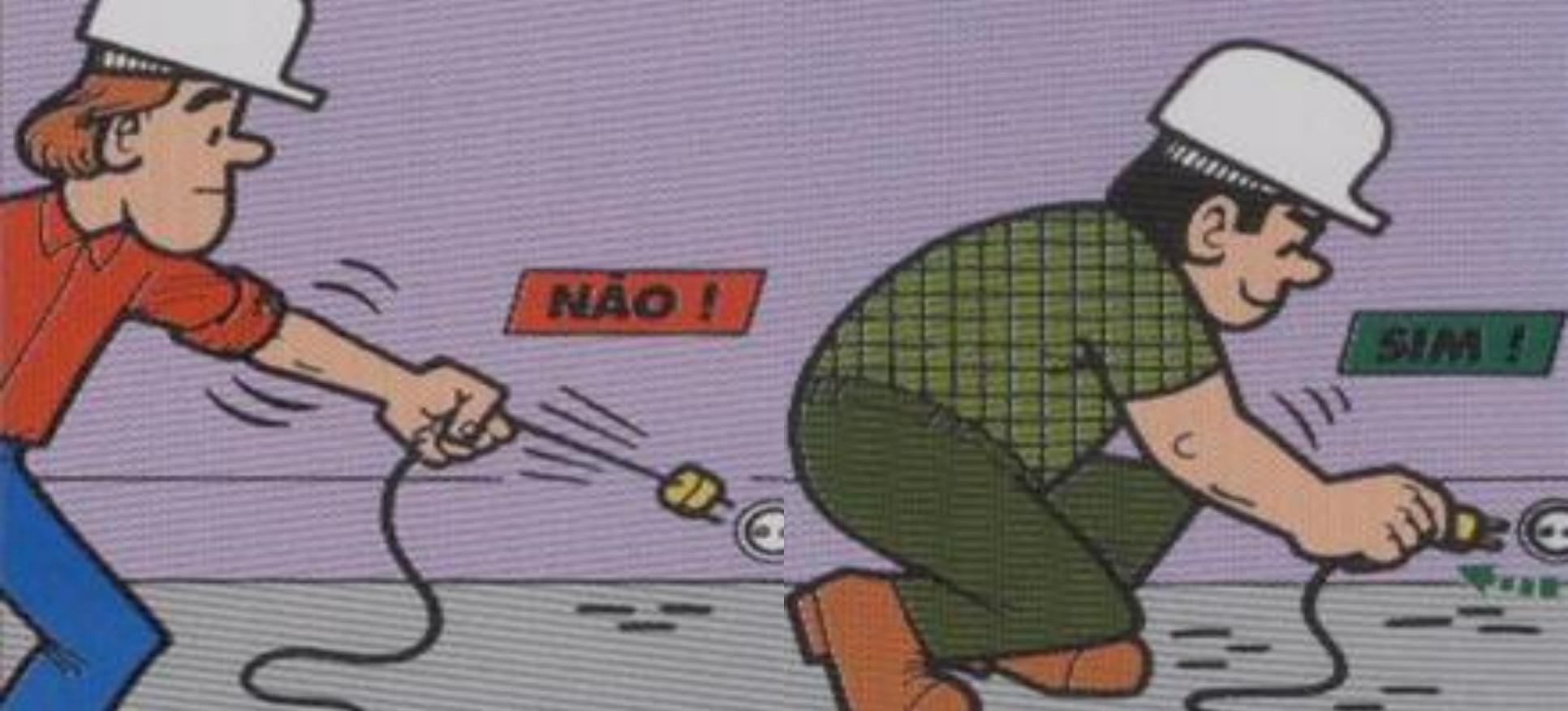
**Para se retirar um plug de uma tomada de corrente deve puxar-se pelo plug, e não pelo cabo de alimentação.**
