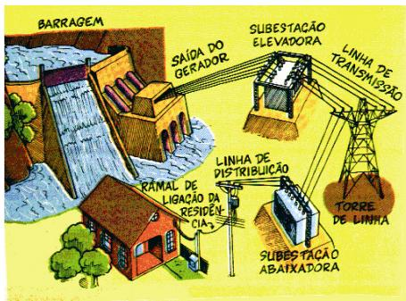
A energia elétrica que alimenta as indústrias, comércio e nossos lares é gerada principalmente em usinas hidrelétricas, onde a passagem da água por turbinas geradoras transformam a energia mecânica, originada pela queda d'água, em energia elétrica.
