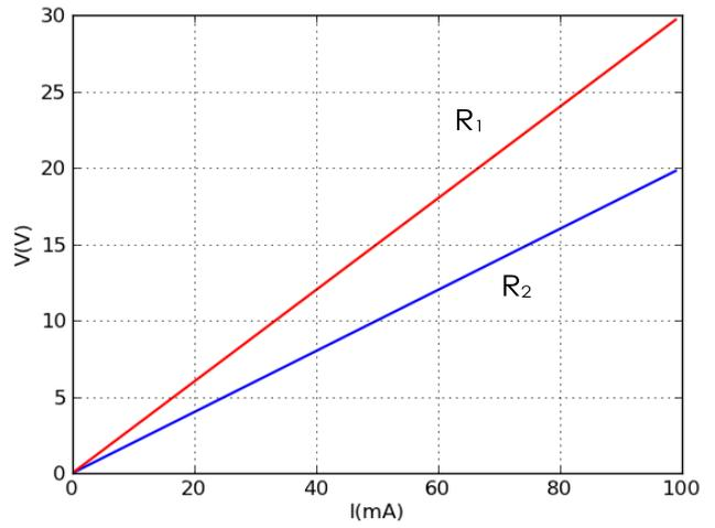
17- Para os seguintes gráficos tensão versus corrente, determine o valor da resistência elétrica dos respectivos resistores.
