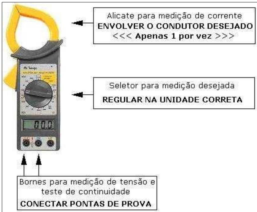
Figura – Alicate Amperímetro modelo ET-3200A (Fonte / cortesia: Minipa)
