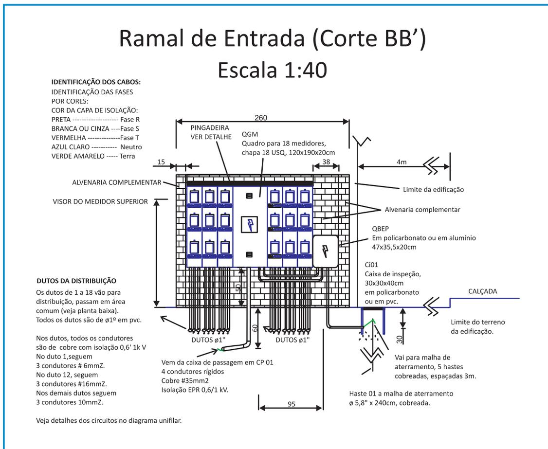
Figura 30 - Exemplo de desenho de detalhe
