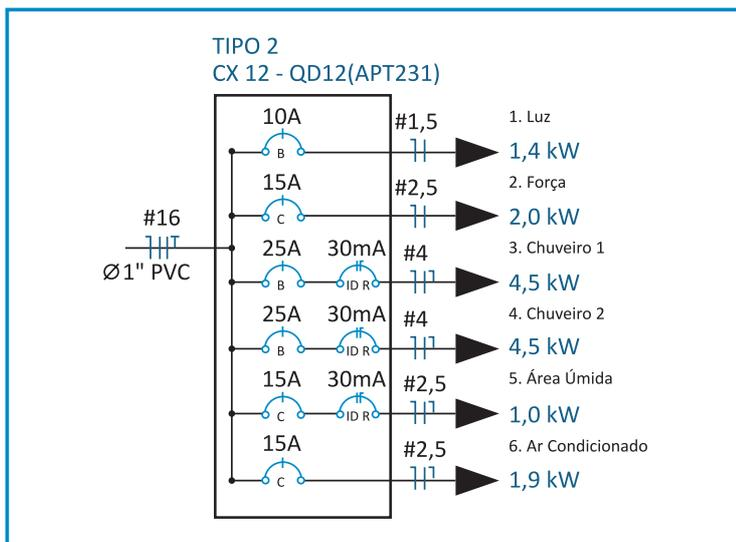
Figura 31 - Exemplo de desenho de esquema
