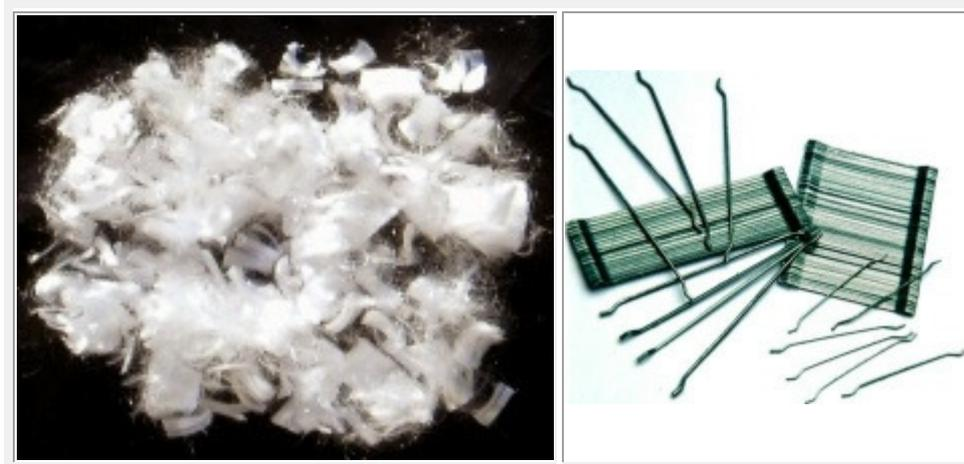
As fibras naturais ou sintéticas são empregadas principalmente para minimizar o aparecimento das fissuras originadas pela retração plástica do concreto.
