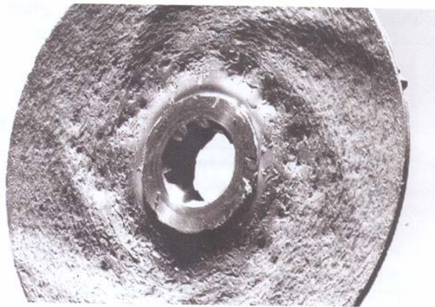
Figura 7.11- Estragos feito em um rotor de bomba devido a cavitação
