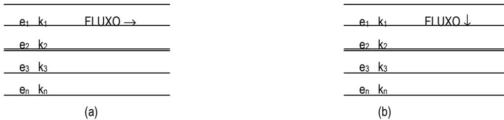
Figura 5: Fluxo nas Direções Horizontal (a) e Vertical (b)
