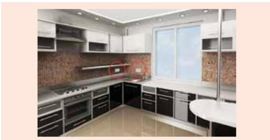
Figura 1 – Pontos de tomada acima da bancada em cozinha
